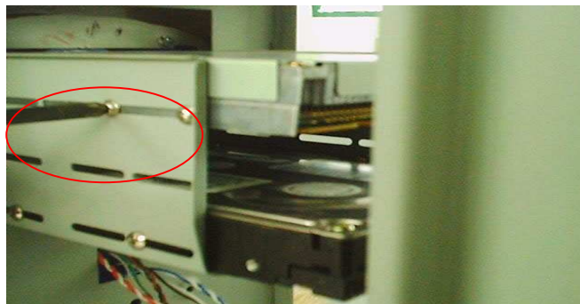
Gambar 2.17 Pemasangan baut FDD
