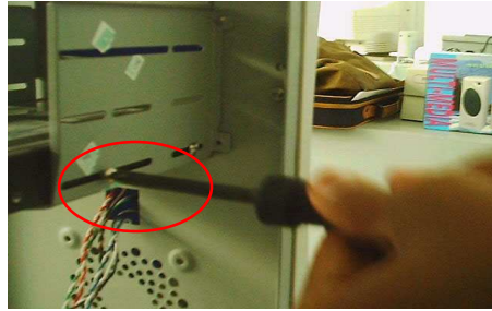
Gambar 2.13 Pemasangan Baut Hard Disk
