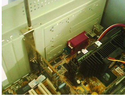
Gambar 2.10 Pemasangan baut VGA Card
