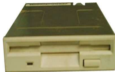
Gambar 1.29 Floppy Disk Drive 5,25 Inch dan Karakteristiknya
